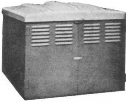
Figura A.3.3.17(b) Caseta de mangueras de acero de dimensiones compactas para instalación sobre un hidrante privado. La caseta se muestra cerrada; su parte superior se abre y las puertas del lado frontal se abren para una accesibilidad completa.
